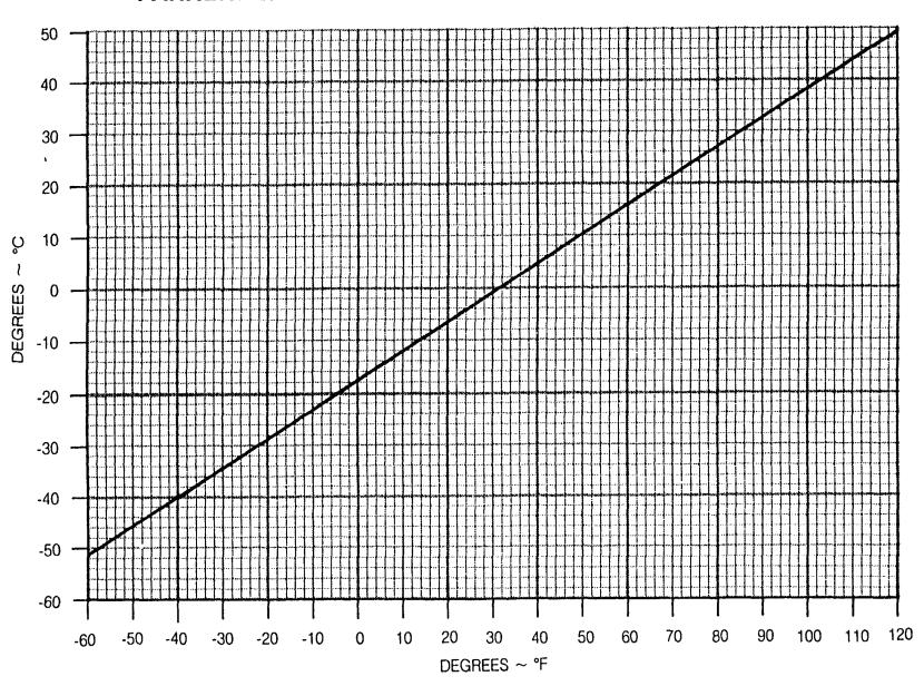
Figure 7A-12. Fahrenheit to Celsius Temperature Conversion
